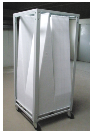
Figura 2: Trattamento fonoassorbente ad impedenza graduale.
